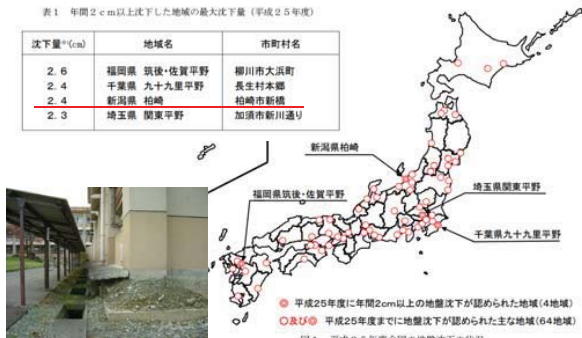
図表:平成25年度 全国の地盤沈下地域の概況(環境省 水・大気環境局、平成26年12月、環境省HP)
